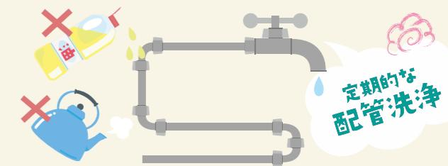
う。プロによる定期的な配管洗浄も長持ちにつながります。配管リフォームの場合、新管と交換する更新工事、既存配管を生かす更生工事の2種類があります。後者では内部の凹凸を取り除いて塗膜で保護するライニング工法が代表的で、前者に比べてコストを抑えられます。
